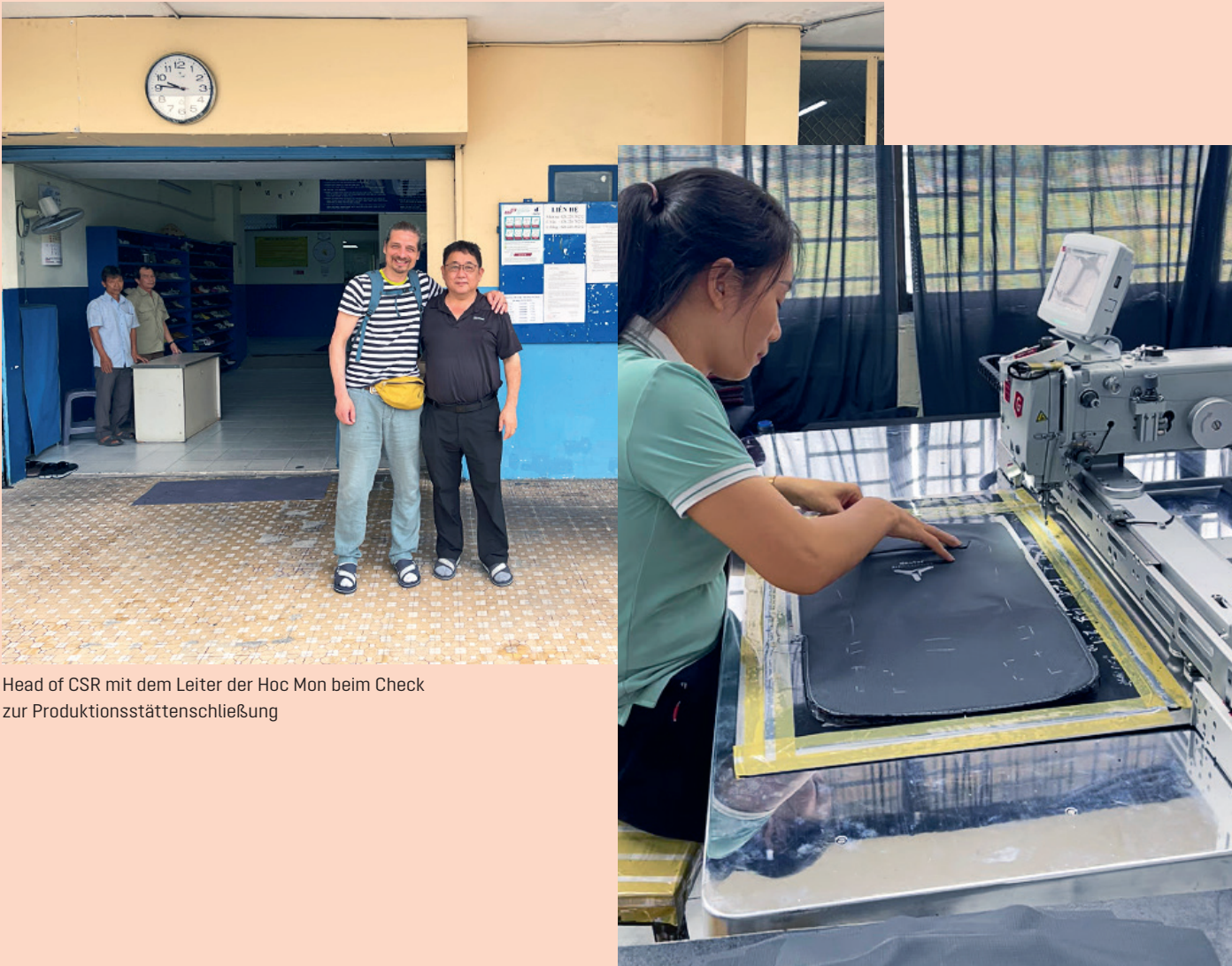
Computernähmaschine für automatisiertes Nähen von Rückenpaneelen
